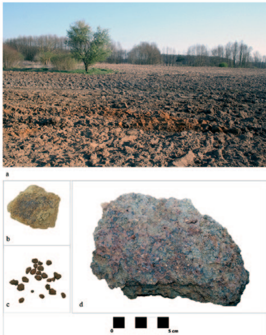
Sl. 3 — Indikativne tvorevine i močvarna željezna ruda: a) izorano tlo crvene boje; b) željezovita pedotvorevina – pjeskovita konkrecija s željezovitim matriksom (tab. 2: 5); c) globularne konkrecije – druga razvojna faza močvarne željezne rude (tab. 2: 3); d) grumen močvarne željezne rude prikupljen iz razorenog ležišta – treća razvojna faza (tab. 2: 4) (fotografija i digitalna obrada: T. Karavidović, 2021.)
