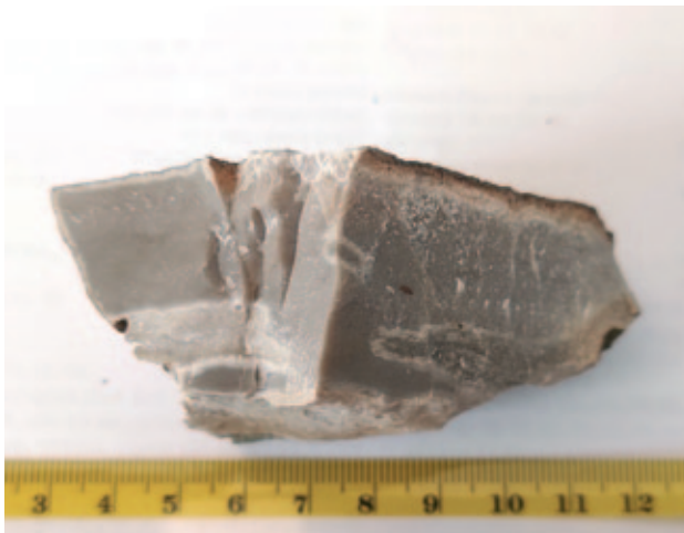
Sl. 15 Uzorak pločastog rožnjaka iz suhozida, Poljaki (snimila: K. Šprem; Šprem 2022: 43, sl. 12 desno) Fig. 15 A sample of platy chert from a drywall in Poljaki (photo by: K. Šprem; Šprem 2022: 43, Fig. 12 right)
