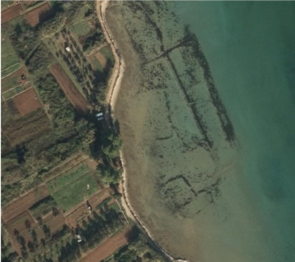
Slika 4 - Zračni snimak potopljene konstrukcije južno od uvale Polačine (Izvor: Arkod)
