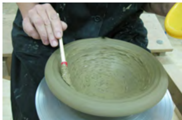
Sl. 9 Izrada unutrašnje površine tarionika Fig. 9 Making the mortarium's interior surface
