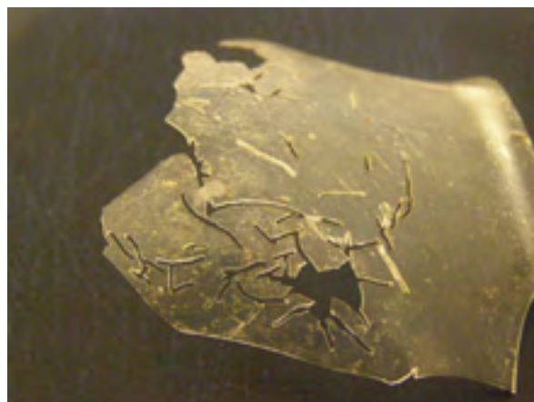
Sl. 5 Proces devetrifikacije Fig. 5 Process of devitrification
