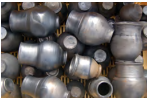
Fig. 26 Saint-Romain-en-Gal: four 2, résultat de la 1 ère cuisson: les pots ont un aspect métallisé dû à la fixation de carbone. (5 e expérimentation, Septembre 2006)
