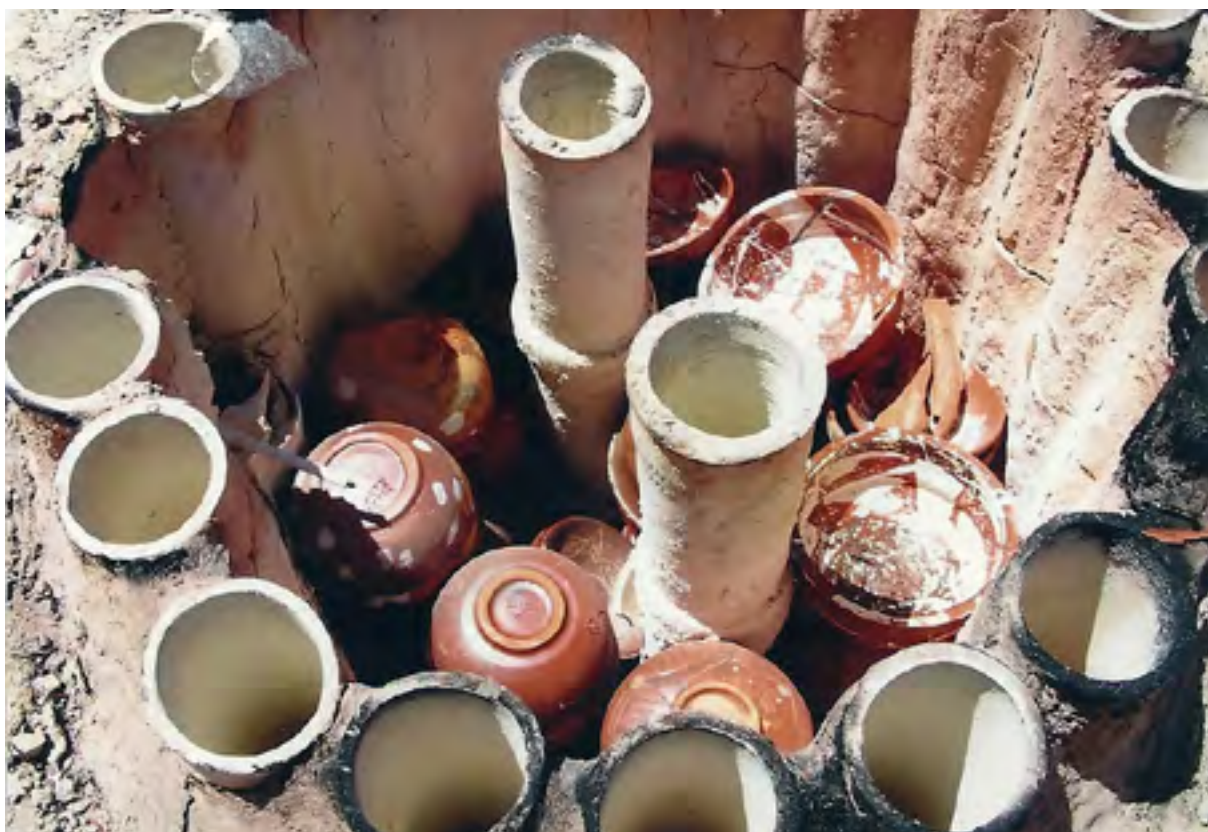
Fig. 10 Biot: défournement du four 1 (mai 2003). La moitié arrière du chargement est légèrement surcuite (on voit trois bols déformés), alors que le vernis de la moitié avant n'est pas vitrifié
