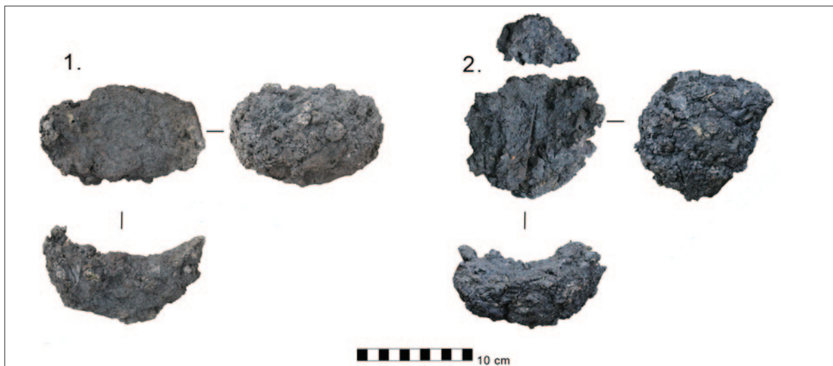
Sl. 3 Spužvasto željezo: 1 Eksperiment 1; 2 Eksperiment 2 (izradila: T. Karavidović)
