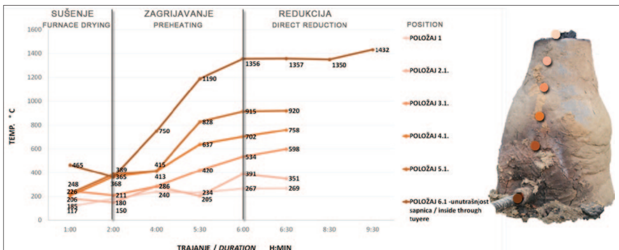
Sl. 4 Temperaturni režim unutrašnjosti peći tijekom postupaka sušenja konstrukcije peći te taljenja (zagrijavanja i redukcije) (izradila: T. Karavidović)
