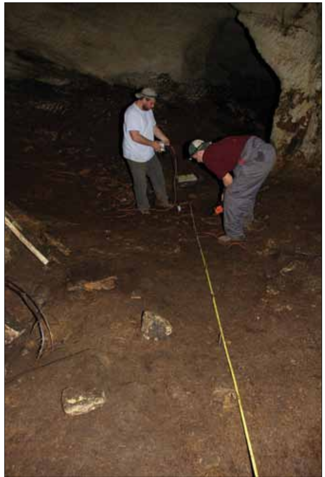
Sl. 23 Eksperimentalno ispitivanje debljine sedimenta nedestruktivnim daljinskim istraživanjem električnom rezistentnom tomografijom – ERT (snimio: I. Karavanić).
