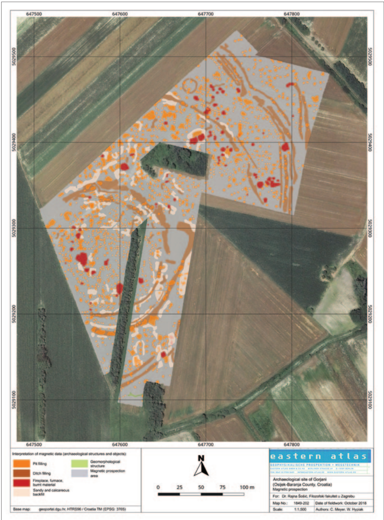
Sl. 20 Gorjani – Kremenjača, interpretacija magnetometrijskoga mjerenja 2018. godine (izradili: C. Meyer i V. Hypiak) Fig. 20 Gorjani – Kremenjača, 2018 magnetic survey interpretation (made by: C. Meyer and V. Hypiak)
