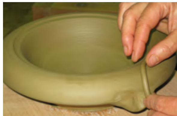
Sl. 7 Izrada otvora tarionika- pomoću gline trake Fig. 7 Making the mortarium's spout - using a clay strip
