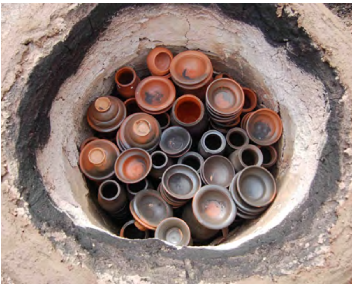
Fig. 22 Saint-Romain-en-Gal: four 1, 9e cuisson (juin 2008) (1080°C). Près de 50% des pots ont un vernis noir. Ils se situent presque tous sur la moitié arrière du four Fig. 22 Saint-Romain-en-Gal: peć 1, deveto pečenje (lipanj 2008.) (1080°C). Gotovo 50% posuda ima crni premaz. Gotovo sve te posude su bile smještene u stražnjoj polovici peći
