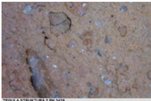
Sl. 5 a) Presjek rimske tegule, nalaz unutar peći "Ignacija" - struktura 2 (snimka: I. Ožanić Roguljić); b) Presjek izrađene opeke za gradnju replike crikveničke peći (foto: G. Lipovac Vrkljan)
