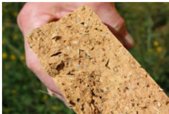
Sl. 5 a) Presjek rimske tegule, nalaz unutar peći "Ignacija" - struktura 2 (snimka: I. Ožanić Roguljić); b) Presjek izrađene opeke za gradnju replike crikveničke peći (foto: G. Lipovac Vrkljan)
