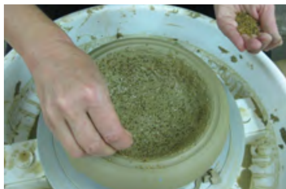
Sl. 10 Stavljanje kvarcnog pijeska na unutrašnju površinu Fig. 10 Applying quartz sand on the interior surface
