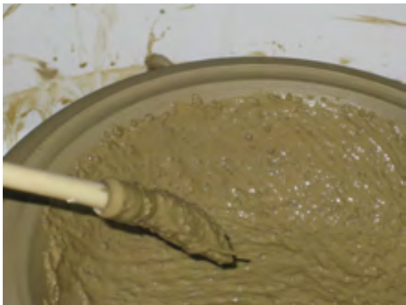
Sl. 11 Izrada unutrašnje površine tarionika - nanošenje kvarcnog pijeska u razmočenoj glini Fig. 11 Making the mortarium's interior surface - applying quartz sand in watered down clay
