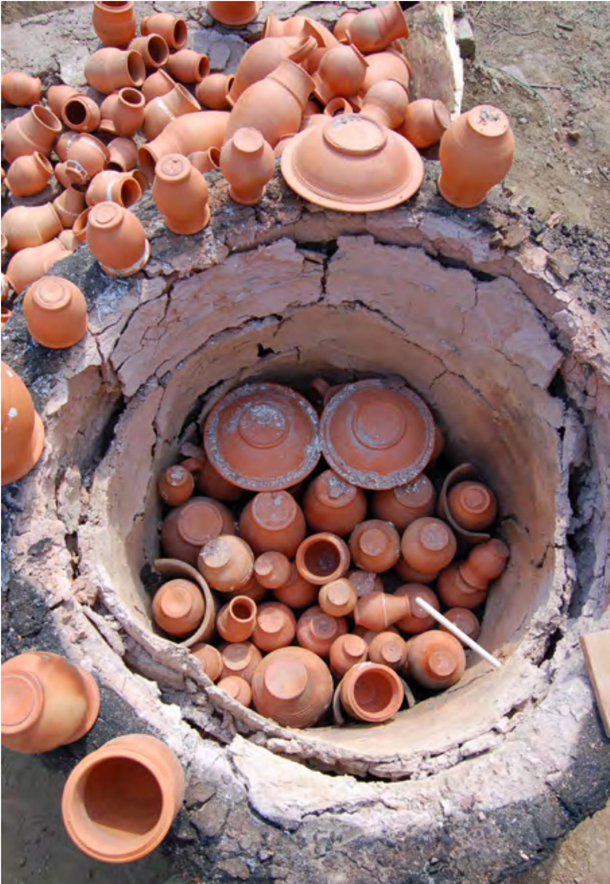
Fig. 20 Saint-Romain-en-Gal: four 1; le défournement après la troisième cuisson (avril 2006) Les vases sortent rouge car le vernis n'a pas grésé, faute d'une température suffisante Fig. 20 Saint-Romain-en-Gal: peć 1: vađenje posuda nakon trećeg pečenja (travanj 2006.) Posude su crvene jer premaz nije verificiran uslijed nedostatno visoke temperature
