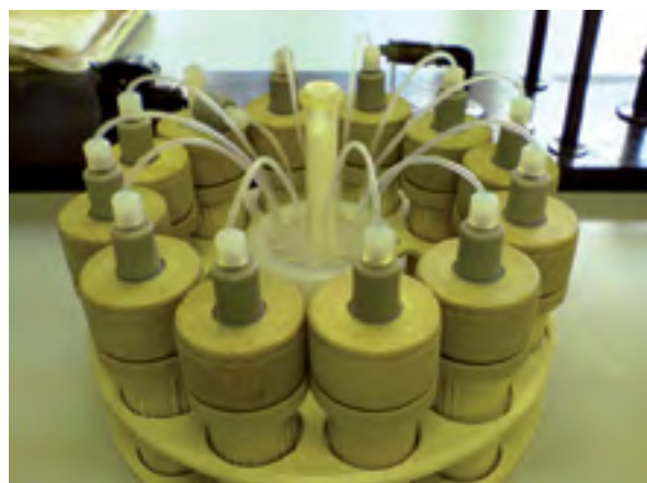
Sl. 3 Rotirajuća ploča s 12 teflonskih posuda mikrovalnog uređaja
