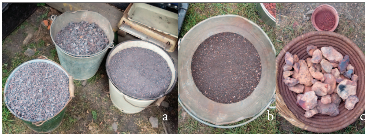
Sl. 3 Tri vrste željezne rude korištene u eksperimentalnim taljenjima za vrijeme trajanja radionice: a) magnetit podrijetlom iz Želehovice (Češka); b) siderit iz regije južna Boca (Slovačka); c) getit iz mjesta Olomučany u regiji Blonsko (Češka) (snimila: T. Sekelj Ivančan)
