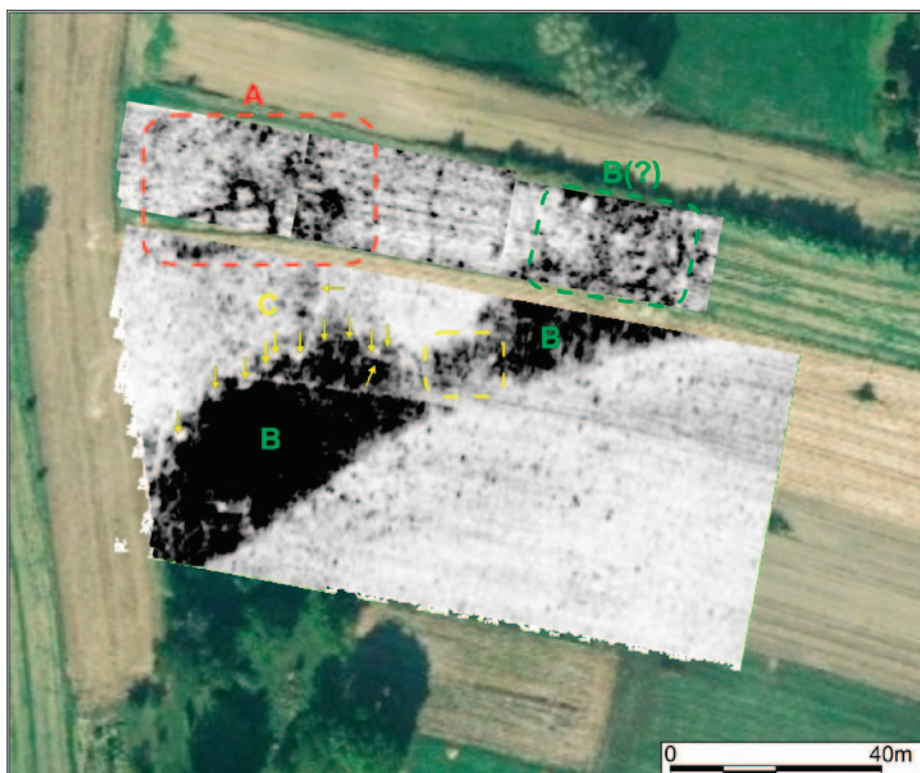
Sl. 3 Rezultati georadarske metode primjenom 400 MHz antene (izradio: B. Mušić)
