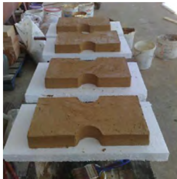
Sl. 8 Sušenje ploča rešetke (foto: Mužek Kaminko d. o. o.) Fig. 8 Drying of slabs for the grid (photo: Mužek Kaminko d.o.o.)
