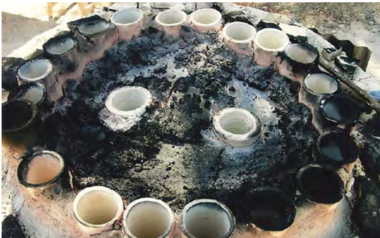
Fig. 9 Biot: le défournement du four à tubulures (Mai 2003). Une des tubulures à gauche a éclaté et plusieurs autres sont fendues. L'atmosphère n'a pu rester oxydante
