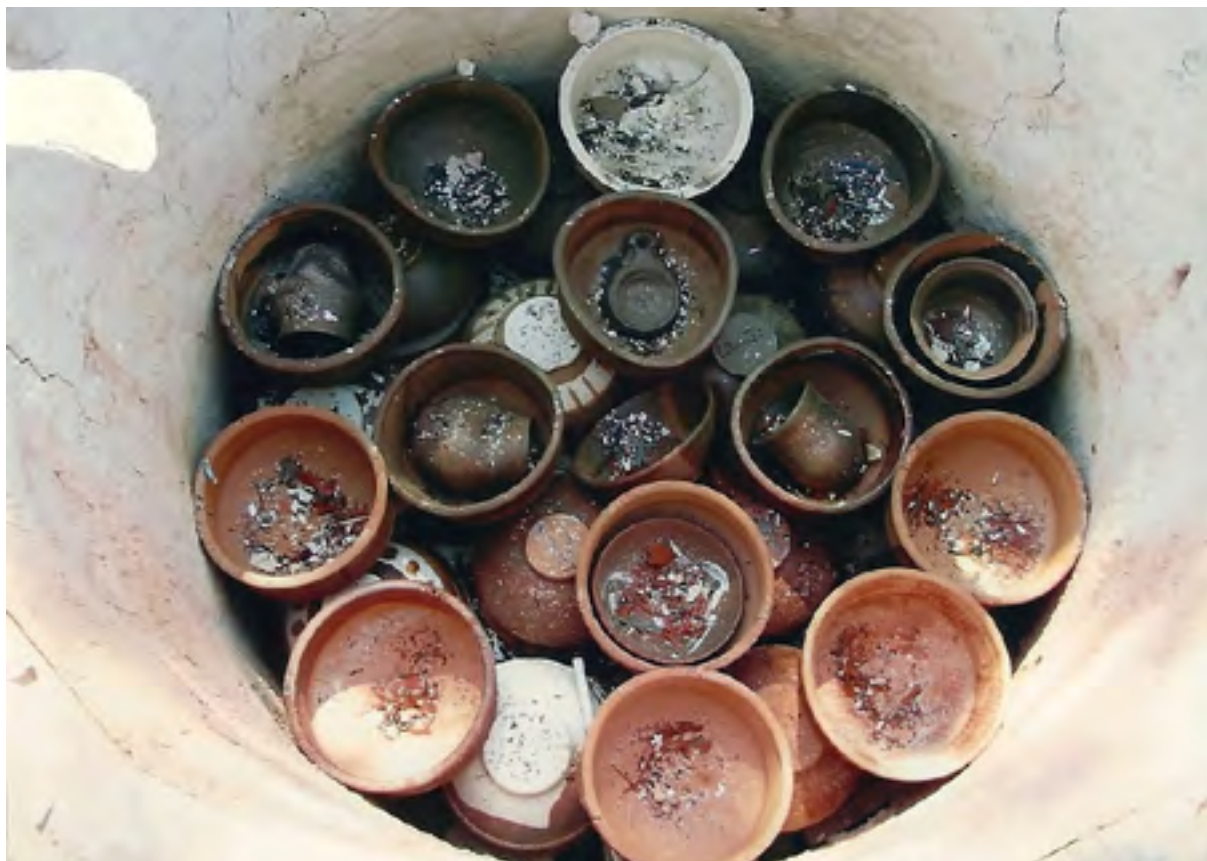
Fig. 8 Biot: le four à tubulures avant le défournement (Mai 2003)
