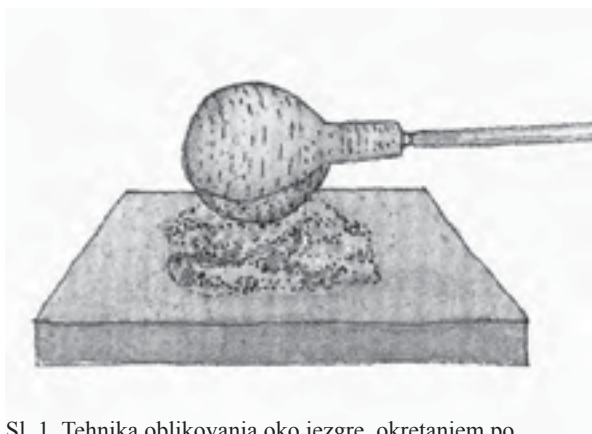
Sl. 1 Tehnika oblikovanja oko jezgre, okretanjem po staklenom prahu (prema: C. Moretti)
